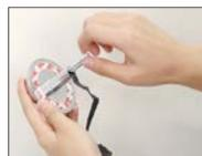
Вкрутите винт в заднюю панель камеры.
