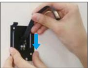
Вставьте винты и провода в монтажное основание.
